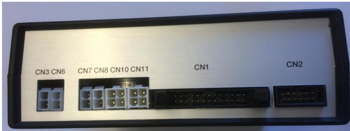
CN1 Flachbandkabelverbindung zum Display
