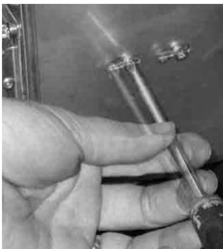
Si les pellets sont extrêmement courts et durs et/ou si le tuyau menant au tuyau de descente est inhabituellement long, les pellets peuvent dans certains cas sauter hors du brûleur. Pour éviter cela, vous pouvez alors monter le frein à pellets fourni. Desserrez la vis montée à l'avant du tuyau de descente. Le frein à pellets se visse de l'extérieur avec la vis fournie (RXS 4,2 x 9,5).
